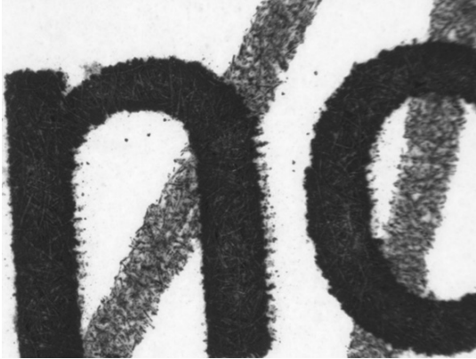
Resim 8. Siyah tükenmez kalem çizgisi altta İnkjet printer yazısı üstte. Siyah tükenmez kalem mürekkebin altta olduğu İnkjet printer yazısının üstte olduğu kesişmelerde herhangi bir parlaklık gözlenmemiştir.
