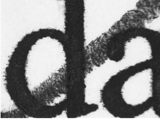
Resim 7. Siyah tükenmez kalem çizgisi üstte ink jet printer yazısı altta. Siyah tükenmez kalem mürekkebin üstte, inkjet printer yazısının altta olduğu örneklerde kesişme noktasında parlak bir görüntü oluşmaktadır.
