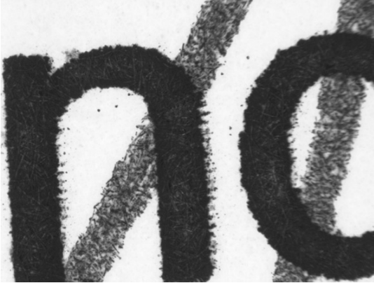
Resim 8. Siyah tükenmez kalem çizgisi altta İnkjet printer yazısı üstte. Siyah tükenmez kalem mürekkebinin altta olduğu İnkjet printer yazısının üstte olduğu kesişmelerde herhangi bir parlaklık gözlenmemiştir.
