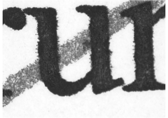
Resim 5. Mavi tükenmez kalem çizgisi üstte ink jet printer yazısı altta. Mavi tükenmez kalem mürekkebinin üstte, İnkjet printer yazısının altta olduğu örneklerde kesişme noktasında parlak bir görüntü oluşmaktadır.
