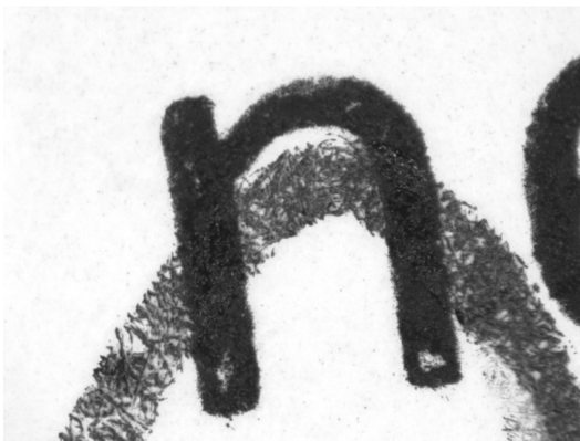
Resim 3. Siyah tükenmez kalem çizgisi üstte lazer printer yazısı altta. Siyah tükenmez kalem mürekkebinin üstte, lazer printer yazısının altta olduğu örneklerde kesişme noktasında parlak bir görüntü oluşmaktadır.
